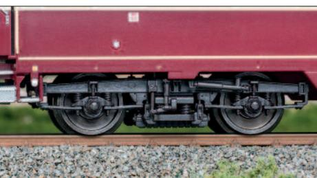
Das MD-367-Drehgestell mit Magnetschienenbremse und Schlingerdämpfer.
